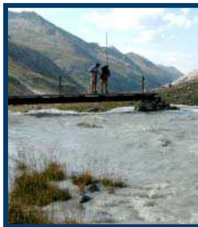
Abflussmessung mit dem „Hydrometrischen Flügel“ bei erschwerten Bedingungen.
